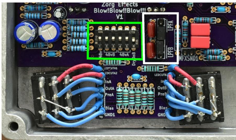
Sur ce mini interrupteur avec six contacteurs, les cinq de gauche servent à l'alimentation phantom. Le premier tout à gauche noté « 48v » sert à allumer l'alimentation phantom pour créer du 48v depuis le 9v. Les deux suivants notés « 48vB » servent à assigner l'alimentation phantom sur le canal B et le deux derniers notés « 48vA » à assigner l'alimentation phantom sur le canal A.
