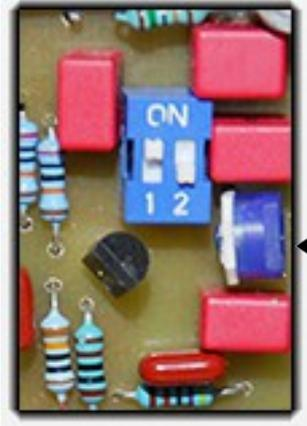
Les mini switches permettent de changer radicalement le grain de la saturation avec les combinaisons suivantes :
