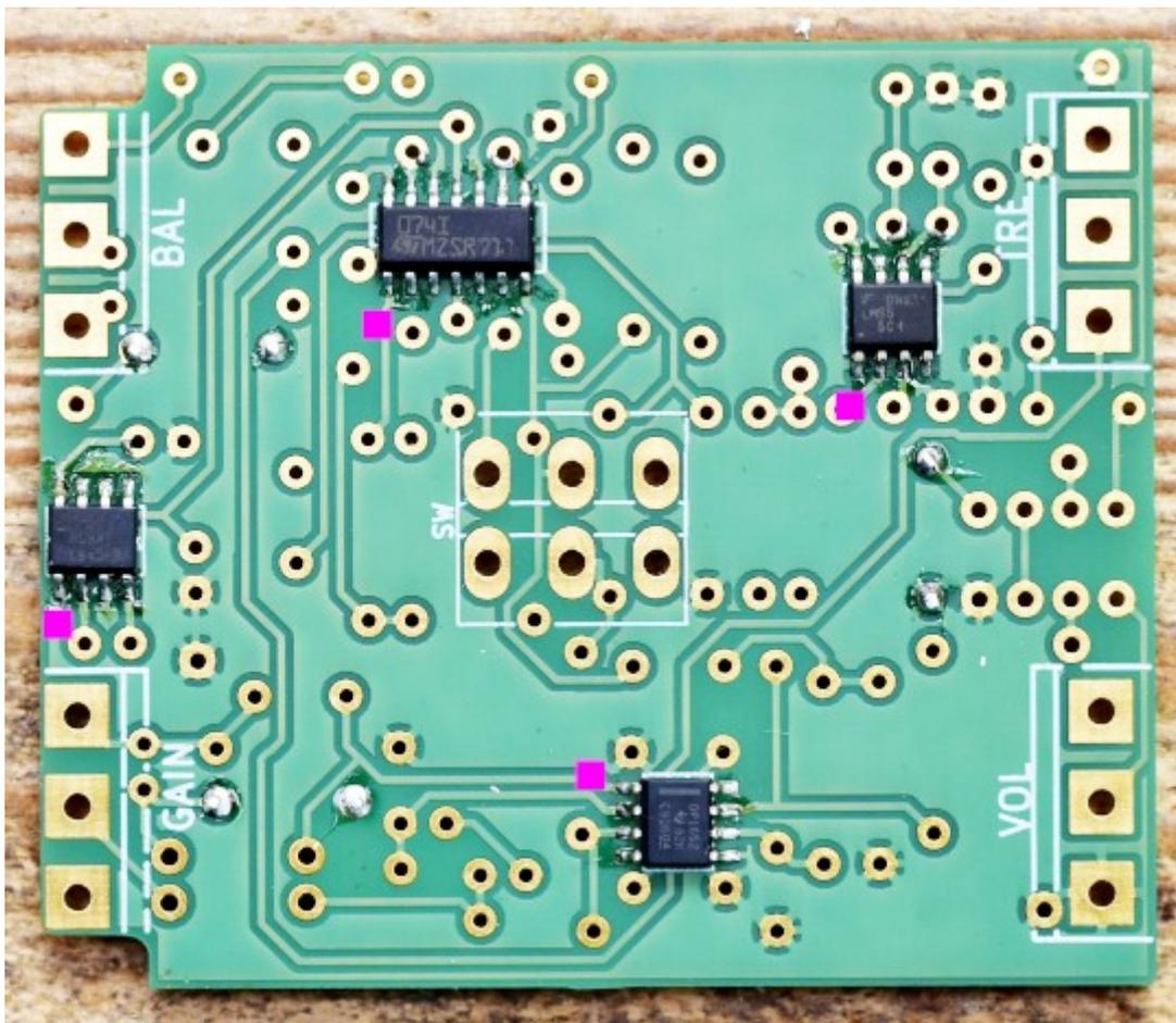
De l'autre coté, nous allons souder les composants sur plus petit au plus gros. Donc d'abord les diodes et les résistances. Attention au sens des diodes, elles doivent absolument être dans le même sens que sur cette image :
