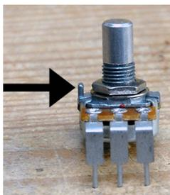
S'il n'a pas déjà un isolant plastique, collez 16mm d'isolant fenêtre sous chaque potentiomètre. Cela sert à ce que le corps du potentiomètre ne fasse pas de court circuit sur les soudures de la carte.
