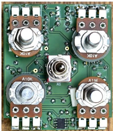
Maintenant insérez la carte dans la boîte et vissez l'écrou de l'interrupteur.
