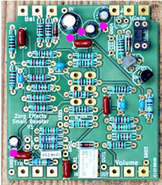
Coupez le socket 9 en ligne pour faire des terminaux pour les entrées sorties (GND1,2,3, IN1 etc...). Dans le **cas de l'option relay true bypass**, il faut insérer deux pins sur l'empreinte notée sw\* et dans IN1 et OUT1. **Sans l'option** relay true bypass, il n'y a pas besoin des pins en sw\*, et il faut insérer les pins dans **IN et OUT** à l'intérieur du cadre du relais inutilisé.
