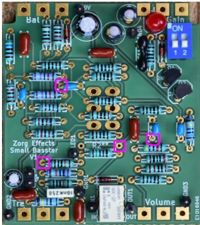
Si vous ne trouvez pas ces tensions, vérifiez avec un voltmètre que vous n'avez pas fait un court circuit de l'alimentation à la masse en faisant une mauvaise soudure.
