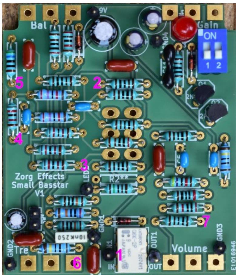
1- C'est l'entrée. Si vous n'avez pas de signal là, cela vient certainement d'une mauvaise soudure sur votre câblage.
