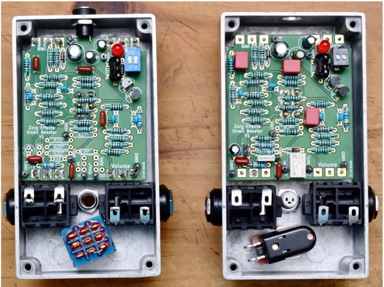
Nous allons câbler comme ça (A droite câblage avec option relay true bypass):
