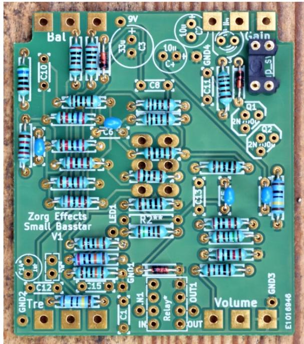
Puis viennent Les capas panasonic/WIMA/KEMET, les transistors (attention aux sens, le méplat doit être du même coté que sur la sérigraphie) et le relais (optionnel) et les condensateurs électrolytiques. Attention au sens des capas électrolytiques, elles doivent être placées avec le coté négatif (bande blanche avec des « - ») indiqué par les points fuchsia de cette photo:
