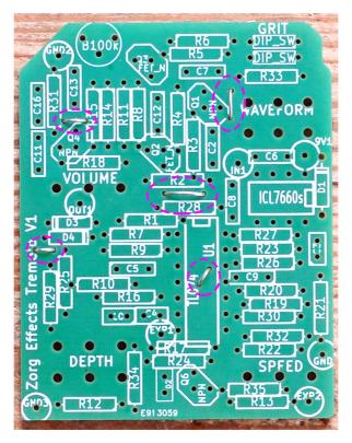
Puis nous allons souder les composants du plus petit au plus gros. Donc d'abord les diodes et les résistances. Attention au sens des diodes, elle doivent absolument être dans le même sens que sur cette image :
