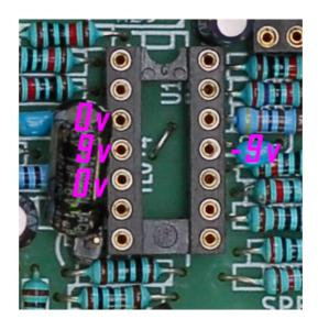
Étape 3: insérez le TL074 dans son socket U1. Après cette étape, lorsque la pédale est branchée et n'est pas en bypass, la led de bypass doit clignoter. Sa vitesse de clignotement donne la vitesse du trémolo et varie en fonction de la position du potentiomètre Rate. Si ça ne marche pas, rendez vous au chapitre « résoudre les problèmes »
