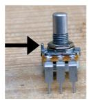
Collez 16mm d'isolant fenêtre sous chaque potentiomètre. Cela sert à ce que le corps du potentiomètre ne fasse pas de court circuit sur les soudures de la carte.
