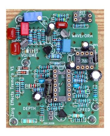
Attention, les capas électrolytiques C4, C10, C12, C3, C6, C8, ont un sens, elles doivent être placées avec la bande blanche du coté indiquées par les flèches sur la photo ci dessous :
